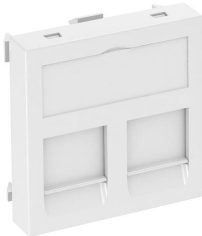
Soporte de datos con salida recta y persianas antipolvo para alojar dos módulos de conexión de datos con toma RJ45. Se puede instalar tanto vertical como horizontalmente. El tipo A tiene una abertura de montaje de 20,10 x 14,80 mm y está diseñado para la fijación directa de los módulos de conexión de datos en la abertura de montaje.
