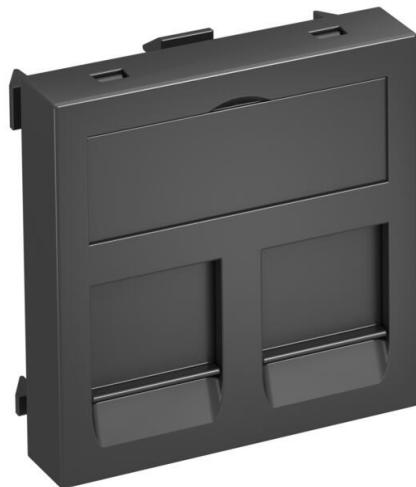
Soporte de datos con salida recta y persianas antipolvo para alojar dos módulos de conexión de datos con toma RJ45. Se puede instalar tanto vertical como horizontalmente. El tipo B tiene una abertura de montaje de 19,35/21,55 x 14,85 mm y está diseñado para la fijación directa de los módulos de conexión de datos en la abertura de montaje.
