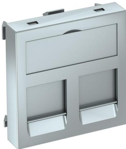
Soporte de datos con salida recta y persianas antipolvo para alojar dos módulos de conexión de datos con toma RJ45. Se puede instalar tanto vertical como horizontalmente. El tipo EP tiene un módulo receptor especial y está diseñado para una fijación indirecta de los módulos de conexión de datos en la abertura de montaje.
