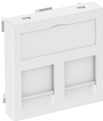
Soporte de datos con salida recta y persianas antipolvo para alojar dos módulos de conexión de datos con toma RJ45. Se puede instalar tanto vertical como horizontalmente. El tipo F tiene un módulo receptor especial y está diseñado para una fijación indirecta de los módulos de conexión de datos en la abertura de montaje.
