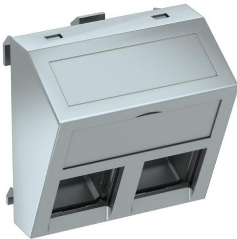
Soporte de datos con salida transversal, sin deslizante de cierre para alojar dos módulos de conexión de datos con toma RJ45. Se puede instalar tanto vertical como horizontalmente. El tipo C tiene una abertura de montaje de 19,30 x 14,80 mm y está diseñado para la fijación directa de los módulos de conexión de datos en la abertura de montaje.
