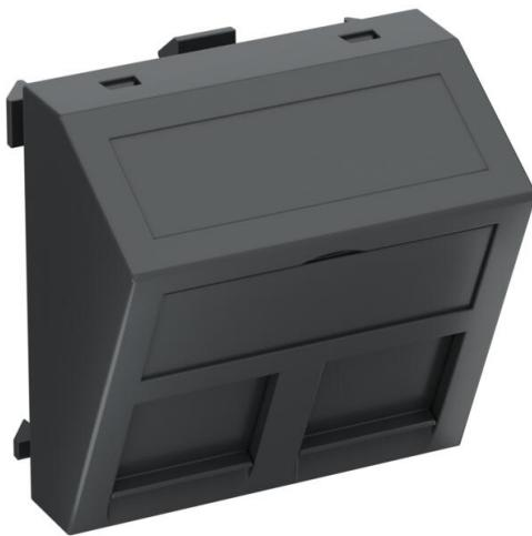
Soporte de datos con descarga oblicua y persianas antipolvo para alojar dos módulos de conexión de datos con toma RJ45. Se puede instalar tanto vertical como horizontalmente. El tipo C tiene una abertura de montaje de 19,30 x 14,80 mm y está diseñado para la fijación directa de los módulos de conexión de datos en la abertura de montaje.
