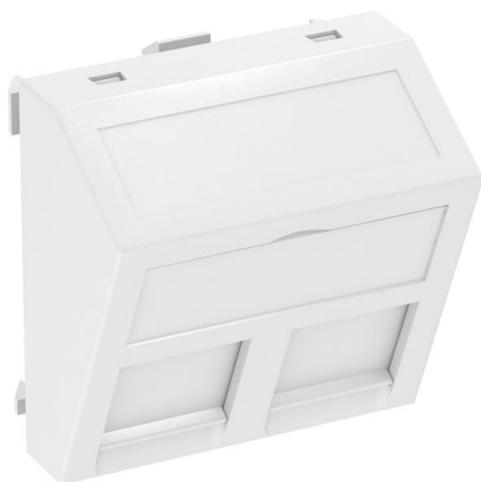
Soporte de datos con salida transversal y deslizable de cierre para alojar dos módulos de conexión de datos con toma RJ45. Se puede instalar tanto vertical como horizontalmente. El tipo PA tiene un módulo receptor especial y está diseñado para una fijación indirecta de los módulos de conexión de datos en la abertura de montaje.
