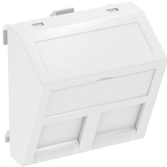
Soporte de datos con descarga oblicua y persianas antipolvo para alojar dos módulos de conexión de datos con toma RJ45. Se puede instalar tanto vertical como horizontalmente. El tipo RM tiene un módulo receptor especial y está diseñado para una fijación indirecta de los módulos de conexión de datos en la abertura de montaje.
