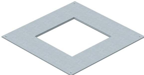
Tapa adaptadora para cajas de derivación y registro bajo suelo del tipo UZD250-3/4 para montar una unidad de instalación de tamaño nominal R4. Abertura de montaje a 3 mm de profundidad para poder cerrarla posteriormente con una tapa ciega.
