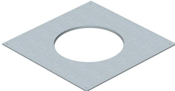
Tapa de montaje para cajas de derivación y de registro bajo suelo del tipo UZD350-3 para montar una unidad de montaje de tamaño nominal R4. Abertura de montaje a 3 mm de profundidad para poder cerrarla posteriormente con una tapa ciega.
