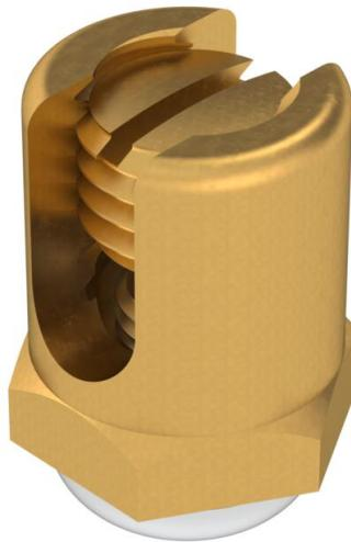
Borne de puesta a tierra para la fijación del conductor de conexión equipotencial en el sistema de bandejas portacables. Pasador roscado M12 con ranura. Adequado para secciones de conductor de entre 4 y 50 mm<sup>2</sup>. Con arandela de seguridad dentada y tornillo de cabeza avellanada.
