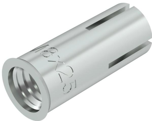
Anclaje de impacto para la fijación individual de sistemas no portantes en hormigón no fisurado y para la fijación múltiple en hormigón fisurado y no fisurado.
