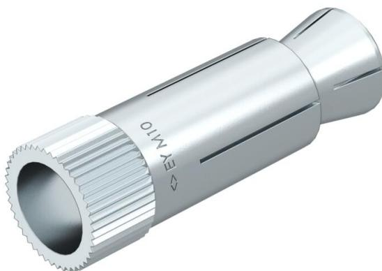
Anclaje para falsos techos Easy para el montaje en placas de falsos techos de hormigón pretensado. Al apretar el tornillo o la tuerca, se suelta el cono del casquillo de anclaje y se introduce en este. De esta forma se extiende el tajo en el hueco y genera un bloqueo. El anclaje para falsos techos también puede utilizarse cuando la zona de expansión no está en una cámara hueca.
