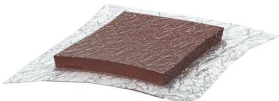
Modelo envasado al vacío del bloque de espuma FBA-B200-14 para el cierre sencillo del espacio residual en el sistema de aislamiento combinado PYRO-PLUG® Block. Tras finalizar el montaje, se corta la hoja y el bloque de vacío se expande de nuevo hasta alcanzar su tamaño original. La hoja puede permanecer en el aislamiento. Uso en interiores.
