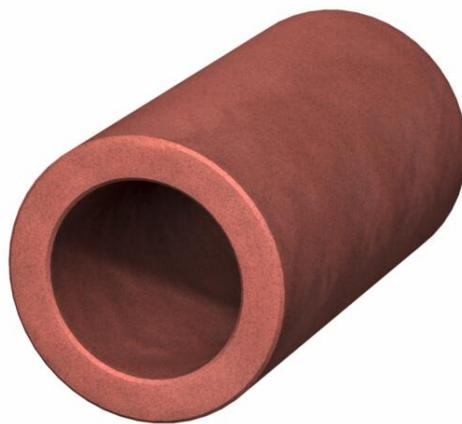
Collarín para tubo vacío para la instalación en el aislante pequeño FBA-SP en tabiques de separación ligeros. Uso en interiores. Proteger el collarín para tubo del agua para garantizar una correcta expansión de la espuma en caso de incendio.
