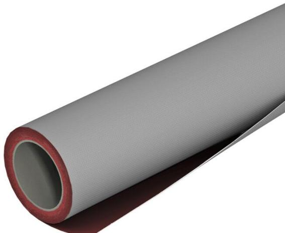
Cubierta protectora contra incendios de tejido flexible y resistente a la intemperie, con revestimiento ignífugo para impedir la propagación de incendios a través de cables y sistemas de bandejas portacables. Exterior gris, interior rojo. Cada rollo tiene 22 m<sup>2</sup>.
