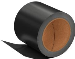
Ángulo de protección contra el fuego revestido por los dos lados con material que hace espuma en caso de incendio para la envoltura de instalaciones en aislamientos de mortero aislante PYROMIX® y placa aislante PYROPLATE® Fibre. El tejido de soporte está provisto del intumesciente por ambas caras. El grosor nominal es de 1,5 mm.
