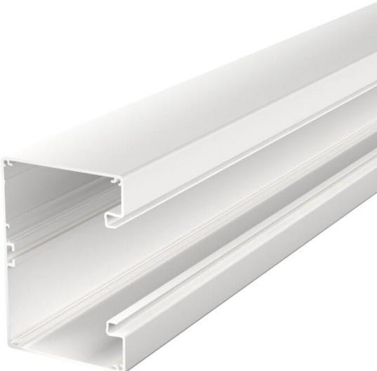
Canal portamecanismos sin perforación en la base para el montaje directo en la pared. Bajo petición se pueden fabricar tramos de canal y tapas de hasta 6000 mm y canales en otros colores RAL. Las superficies visibles de los canales portamecanismos están foliadas.
