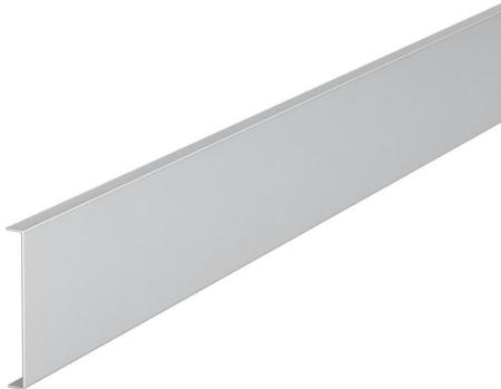
Tabique separador para dividir los canales Rapid 80 GA, Rapid IBIS de aluminio y las columnas de instalación eléctrica ISS para la instalación de distintos circuitos. En el montaje vertical de canales portamecanismos, y en la instalación de las columnas de instalación eléctrica ISS, es necesario la grapa para canal tipo KL80A para la fijación segura del tabique separador.
