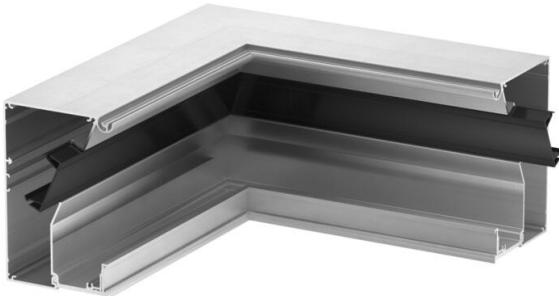
Parte inferior del ángulo interior para la creación de un canal portamecanismos de diseño de la serie GAD. Abertura de sistema de 45 mm para montar equipos de conmutación y conexión Modul 45 y sus tapas correspondientes de PVC y aluminio de la serie Rapid 45. La pieza preformada puede completarse con cubiertas de diseño "Swing", "Soft" o "Style". Son obligatorios los adaptadores de tapa GAD OTA. Entre las cubiertas del canal debe insertarse una pieza distanciadora GAD OTD.
