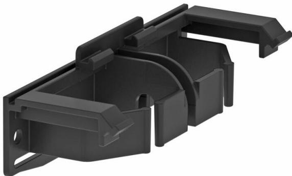
Adaptador de tapa para montaje de bases de canales y piezas preformadas de las series de canal portamecanismos GAD y Rapid IBIS. El adaptador de tapa puede deslizarse en una guía en la parte inferior y sirve para alojar la cubierta de canal, manteniéndola a la distancia deseada. También sirve para la versión de cables enlazada y puede desplazarse la dirección de longitud. Debe mantenerse una distancia máxima de 50 cm entre los adaptadores de la tapa.
