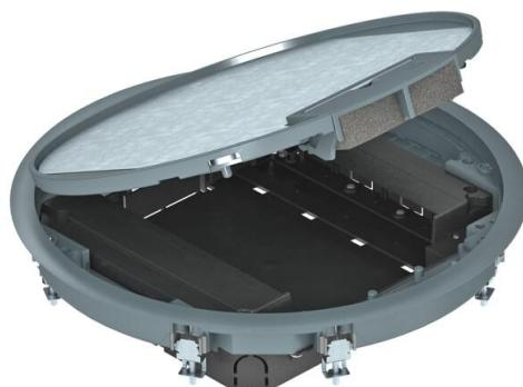
Caja portamecanismos GESR9 con una altura de instalación fija de 55 mm en interior. Dispone de dos cubetas para el montaje vertical de mecanismos Modul 45 y cuatro descargadores de tracción. Es necesario usar dos marcos de montaje para instalar los mecanismos Modul 45.
