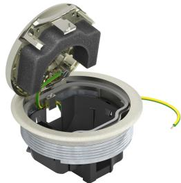
Unidad de montaje redonda con marco para acabado de pavimento para montaje directo en la unidad de conexión UDL2-120. Cuando la unidad está cerrada se puede limpiar con agua. La profundidad mínima de montaje es de 70 mm.
