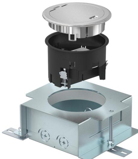
Unidad de instalación redonda GES R2 con tapa abatible, marco de protección revestimiento de suelo y caja para solado UD GES R2 para instalación en suelos de pavimento continuo Se suministra con una toma de corriente doble con puesta a tierra con contactos desplazados 33°. En el lateral, junto a la toma, se pueden conectar hasta 2 conectores de datos. Cuando la unidad está cerrada se puede limpiar con agua. La profundidad mínima de montaje es de 85 mm. Superficie cromada.
