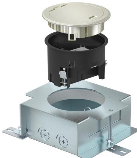
Unidad de instalación redonda GES R2 con tapa abatible, marco de protección revestimiento de suelo y caja para solado UD GES R2 para instalación en suelos de pavimento continuo Se suministra con una toma de corriente doble con puesta a tierra con contactos desplazados 33°. En el lateral, junto a la toma, se pueden conectar hasta 2 conectores de datos. Cuando la unidad está cerrada se puede limpiar con agua. La profundidad mínima de montaje es de 85 mm. Superficie niquelada.
