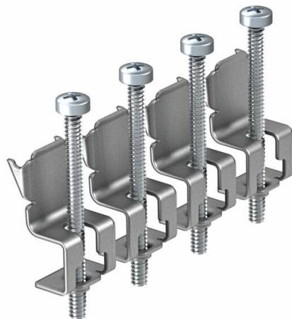
Cuatro fijaciones universales para unidades portamecanismos y unidades de cajas de conexiones redondas de los tamaños nominales R4, R7 y R9 en sistemas de canalización, suelos técnicos y huecos, y unidades portamecanismos y unidades de cajas de conexiones cuadradas de los tamaños nominales 4, 6 y 9 en sistemas de canalización. Para fijar el conjunto portamecanismos GRAF9 se necesitan ocho fijaciones universales. Pieza de repuesto.
