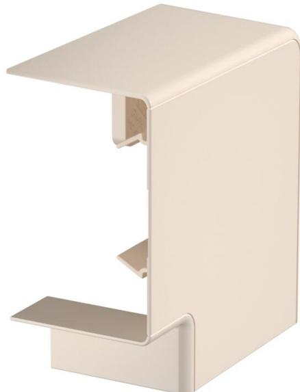
Accesorio de ángulo plano fabricado en PC/ABS libre de halógenos para crear fácilmente un cambio de dirección ascendente o descendente de 90° con los canales portamecanismos de las series Rapid 80 GK, GKH, GS y GA. La tapa para ángulo plano se puede utilizar con canales simétricos y asimétricos. La tapa se debe pedir por separado.
