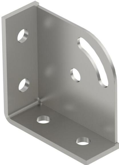
Ángulo de montaje reforzado con 6 agujeros para la unión de perfiles de 41 × 41 mm y 41 × 21 mm en un ángulo de 90°. Posibilidad adicional de fijación de un puntal en un ángulo de 45° con posibilidad de ajuste de +/- 30°. Utilización para ángulos de 15° a 75°.
