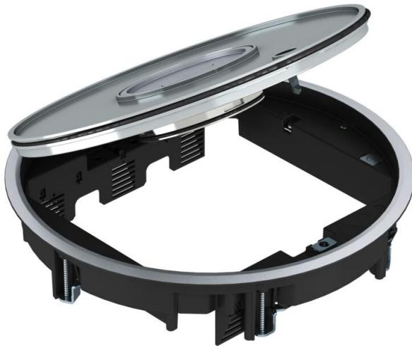
Conjunto portamecanismos con tubo para suelos que precisan una limpieza con agua para un máximo de 12 mecanismos individuales Modul 45 en 3 soportes universales UT4, montaje en sistemas de canalización y suelos modulares.
