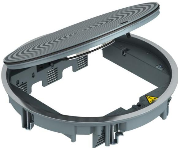
Conjunto portamecanismos con tubo para suelos que precisan una limpieza con agua para un máximo de 12 mecanismos individuales Modul 45 en 3 soportes universales UT4, montaje en sistemas de canalización y suelos modulares. Se pueden instalar hasta 9 mecanismos con placa central de 50. Conjunto portamecanismos con tubo para suelos que precisan limpieza con agua, 3 huecos para el montaje de cubetas MT9. Pueden instalarse 3 tapas ciegas protectoras APMT5.
