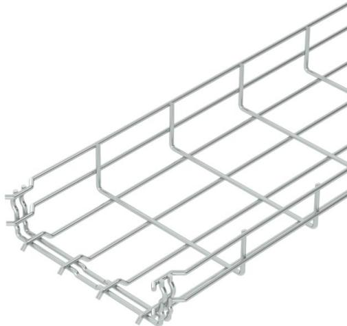
Bandeja de rejilla con conexión de unión rápida con ala de 55 mm. Para la bandeja de rejilla no se necesita ningún tipo de unión, simplemente se engancha un tramo con otro. El ancho de malla es de 50 x 100 mm (excepción GRM 55/50 = 20 x 100 mm).
