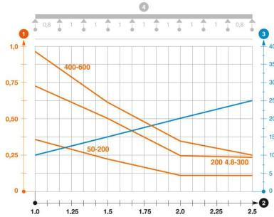
Diagrama de carga bandeja de rejilla C tipo GRM 55 VA
