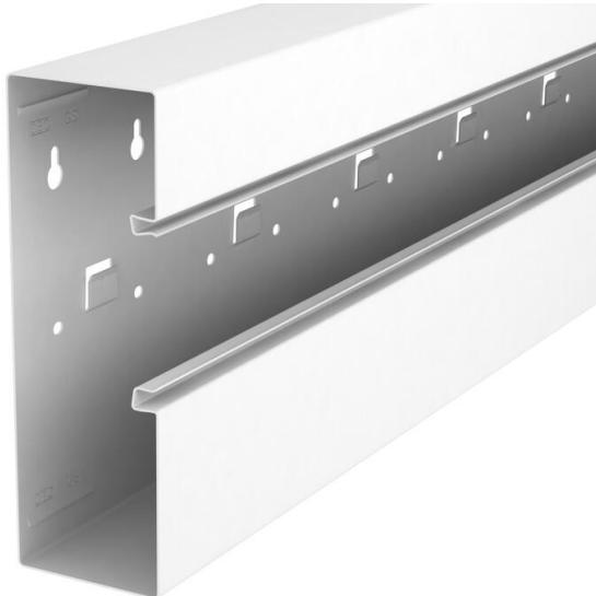
Canal portamecanismos GS para el montaje directo en la pared o en consolas de fijación. El canal portamecanismos GS dispone de unas pestañas en su base para colocar el tabique separador. La conexión equipotencial entre las bases de dos tramos de canal está garantizada gracias a las uniones. La conexión equipotencial entre la tapa y el cuerpo está asegurada al colocar la tapa. La abertura del sistema mide realmente 76,5 mm. La tapa se debe pedir por separado.
