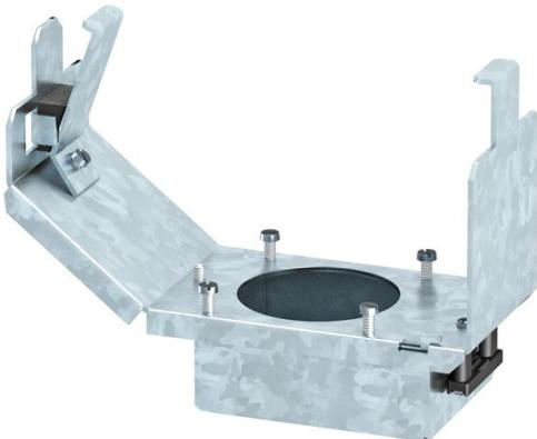
Cubeta de tamaño nominal 2 para el montaje de una toma CEE de 16 A o 32 A en conjuntos portamecanismos y conjuntos de tapa y marco de tamaño nominal 2, 4, 6 y R7. Profundidad mínima necesaria de montaje: 190 mm. Profundidad de instalación mínima requerida: 190 mm cuando se usa un enchufe recto y 160 mm cuando se usa un enchufe en ángulo.
