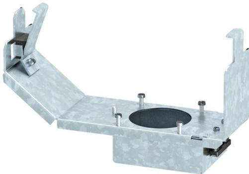
Cubeta de tamaño nominal 3 para el montaje de una toma CEE de 16 A o 32 A en conjuntos portamecanismos y conjuntos de tapa y marco de tamaño nominal R7, 9 y R9. Profundidad mínima necesaria de montaje: 190 mm. Profundidad de instalación mínima requerida: 190 mm cuando se usa un enchufe recto y 160 mm cuando se usa un enchufe en ángulo.
