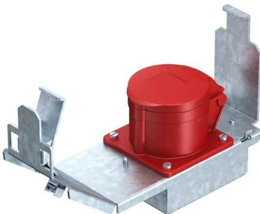
Cubeta de tamaño nominal 3 para el montaje de una toma CEE de 16 A en conjuntos portamecanismos y conjuntos de tapa y marco de tamaño nominal R7, 9 y R9. Profundidad mínima necesaria de montaje: 190 mm y 160 mm si se usa un conector angular. Profundidad de instalación mínima requerida: 190 mm cuando se usa un enchufe recto y 160 mm cuando se usa un enchufe en ángulo.
