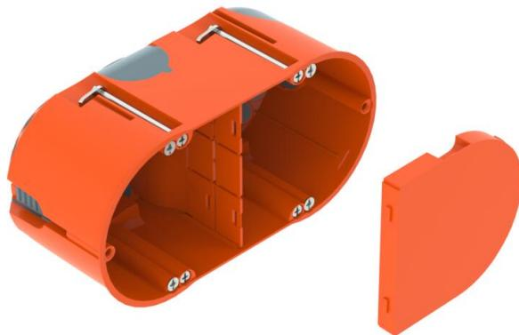
Caja electrónica para paredes huecas con entradas de membrana, tapa y tabique de separación, para el uso en paredes huecas con una profundidad de montaje de mínimo 61 mm y un grosor de placa de 5 - 40 mm.
