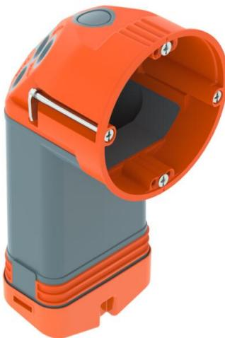
Caja portamecanismos para paredes huecas con entradas de membrana y bolsa de elastómero para espacio de cableado adicional, para el uso en paredes huecas con una profundidad de montaje de mínimo 61 mm y un grosor de placa de 5 - 30 mm.
