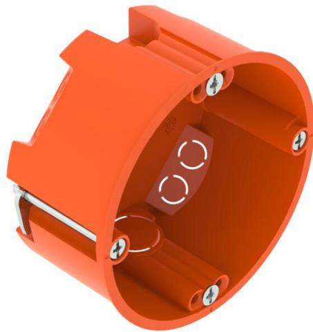
Caja portamecanismos para paredes huecas para el uso en paredes huecas con una profundidad de montaje de mínimo 35 mm y un grosor de placa de 5 - 28 mm.
