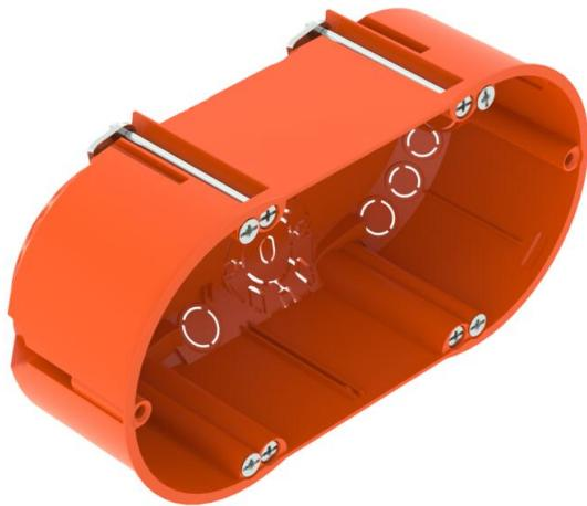
Caja portamecanismos para paredes huecas doble para el uso en paredes huecas con una profundidad de montaje de mínimo 47 mm y un grosor de placa de 5 - 40 mm.
