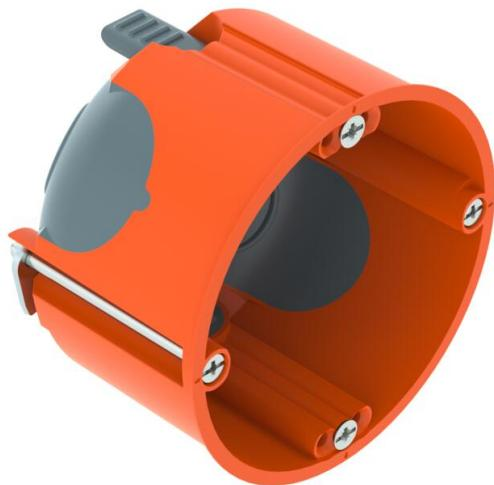
Caja portamecanismos para paredes huecas con entradas de membrana herméticas, para el uso en paredes huecas con una profundidad de montaje de mínimo 47 mm y un grosor de placa de 5 - 40 mm. • 2 x 3 domos roscados
