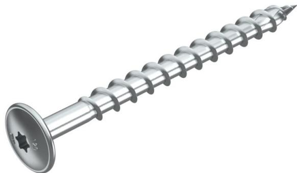
Tirafondo autorroscante para una fijación segura contra incendio de instalaciones de cables para el mantenimiento de función según DIN 4102 parte 12 en componentes de madera portantes. La forma de la cabeza de la placa permite el montaje sin arandela adicional.
