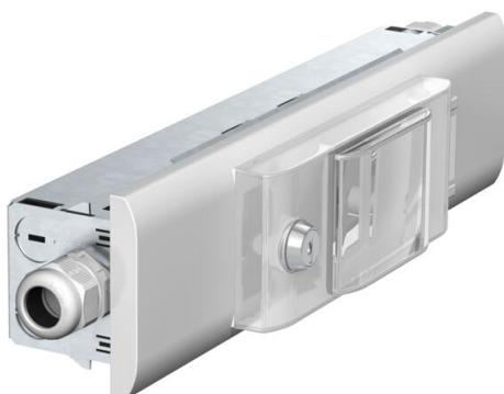
Unidad de instalación para montar disyuntores o interruptores diferenciales en canales portamecanismos de las series Rapid 80 GK, GS y GA. Con 1 carril DIN 3 TE. Bornes en línea para N y PE completamente cableados en carril DIN de 6 mm<sup>2</sup>. La sección del cable es de 6 mm<sup>2</sup>. La unidad de montaje está precableada. Se suministra con 2 prensaestopas V-Tec M20. En cada lado pueden montarse como máximo 3 prensaestopas M20 o 1 prensaestopa M25.
