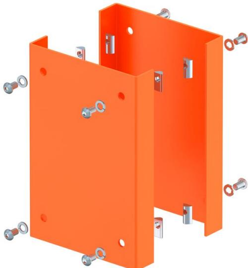
Protección contra choques como protección mecánica de la columna de distribución eléctrica industrial ISS en la zona del suelo. Dentro del volumen de suministro se incluyen dos perfiles de protección con forma de U de 3 mm de chapa de acero, y 8 tornillos de fijación con tuercas de ranura para el montaje en el perfil de la columna.
