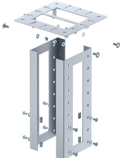
Fijación para techo para columna de distribución eléctrica industrial ISS. En el volumen de suministro se incluyen 2 perfiles en forma U de 3 mm de chapa de acero, la placa de fijación para el techo y los accesorios de montaje necesarios incluidas las tuercas de ranura. En el perfil de la columna se puede regular la altura de la fijación al techo.
