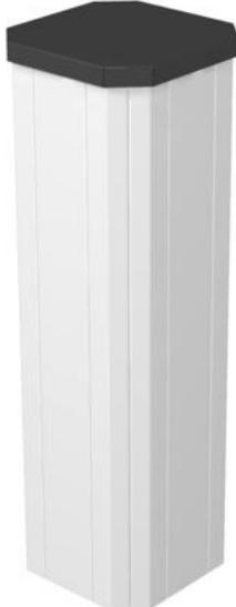
Minicolumna ISS de chapa de acero a 4 caras con tapa de 76.5mm. Se pueden instalar como máximo 6 mecanismos estándar en cada cara, en total 24 mecanismos. Se puede fijar directamente en el suelo. Las cajas portamecanismos deben pedirse por separado. La minicolumna se pueden equipar con las cajas portamecanismos de la serie 71GD...
