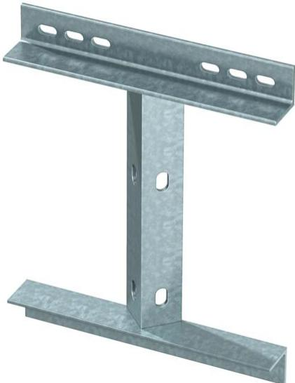
Placa adaptadora con agujeros alargados para fijación universal en vigas de acero y paredes. En la placa adaptadora se atornillan la escuadra de pared y perfil en un ángulo de 45°.
