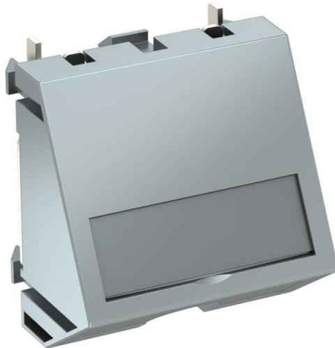
Salida de cables de 2 piezas con campo identificativo, compuesta de un soporte con descarga de tracción y cubierta. La descarga de tracción está diseñada para diámetro de cable de 3 - 11 mm. Se puede instalar tanto vertical como horizontalmente.
