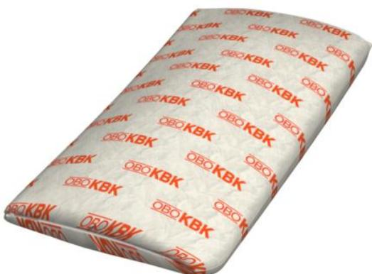
Almohadilla intumescente de cables hecha de tejido de vidrio de malla estrecha, denso y mecánicamente sólido, con un relleno especial. Sin fibras minerales, resistente a la intemperie y resistente al agua. Uso en interiores. Almacenable de forma ilimitada en estancias secas y protegidas contra las heladas.
