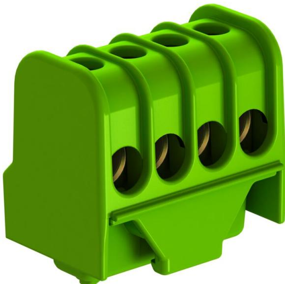
Borne de conexión con toma de tierra, regleta de bornes de latón, tornillos de acero, electrogalvanizados y con pasivado transparente, sección nominal 6 ÷ 16 mm<sup>2</sup>, tensión nominal 400 V, 1 polo, con bloques de terminales, conductor máx. que se puede conectar en cada borne máx. 4x16 mm<sup>2</sup>, 4x10 mm<sup>2</sup>, 8x6 mm<sup>2</sup> o 12x4 mm<sup>2</sup>.
